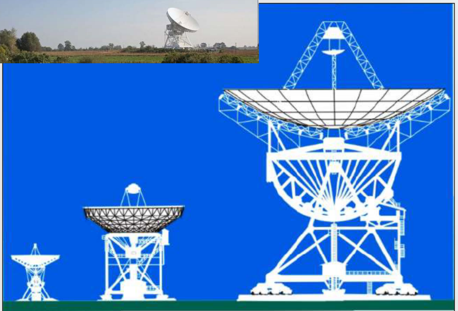
Radioteleskopy CA UMK. 15-m RT3, 32-m RT4 i propozycja inż. Zygmunta Bujakowskiego (projektanta dwu poprzednich) 70-m radioteleskopu RT5. Projekt RT5 jest też rozważany jako możliwe rozwiązanie konstrukcyjne dla 90-m anteny
